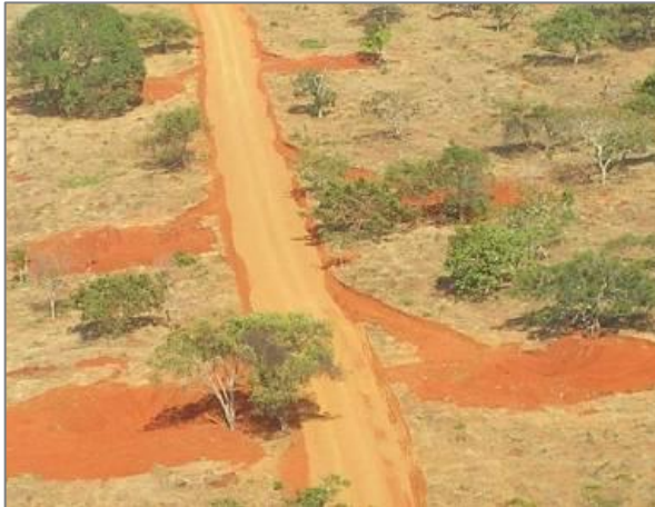
Figuras 8, 9, 10 e 11: Exemplos de Barragem Tipo 1 – Lombada, bigode e barragem
